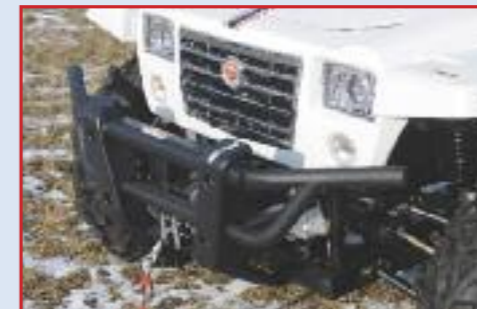
Kräftig: Rohrbumper mit 3000-lbs-Winde
